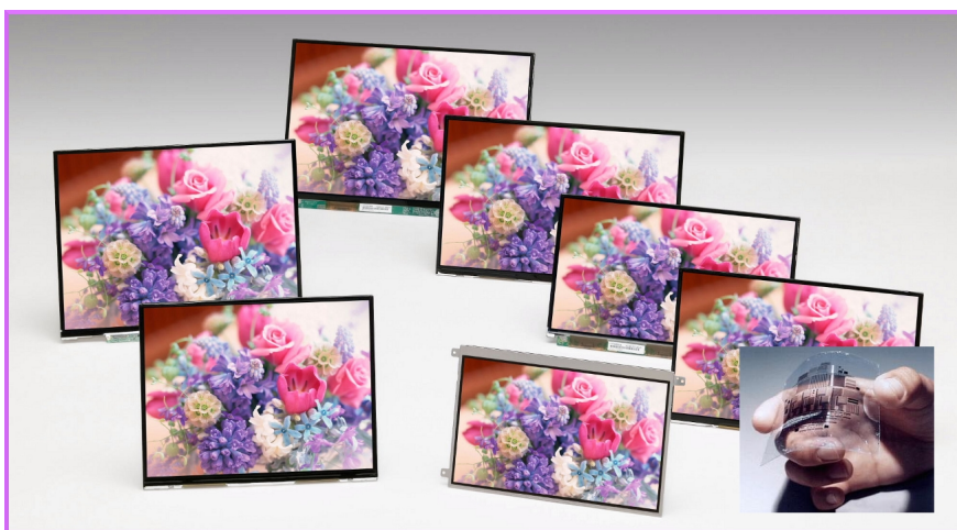
Figura 1: Toshiba Matsushita Display Technology Co. mostra un prototipo di display LCD per notebook costituito interamente da transistor organici a film sottile (OTFT) accoppiati ai cristalli liquidi; in basso a destra un circuito di fabbricato interamente con transistor organici a film sottile(OTFT).
